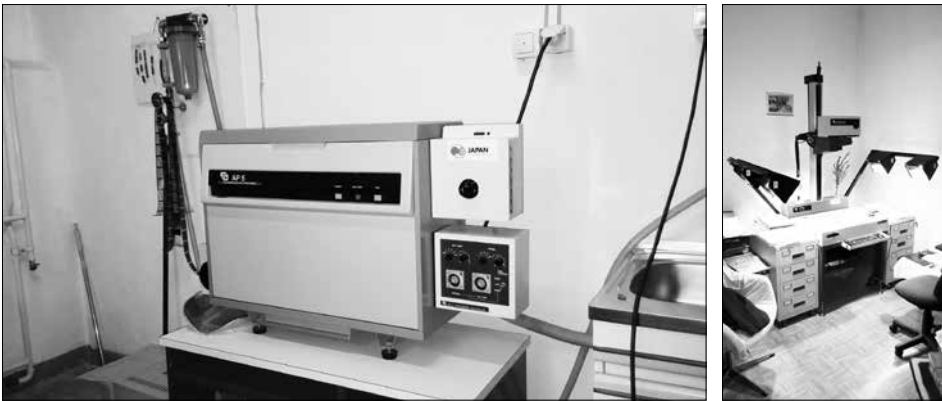
Fuji AP5 procesor i Hiramawa 35mm ručna kamera za mikrofilmiranje u Arhivu Bosne i Hercegovine
